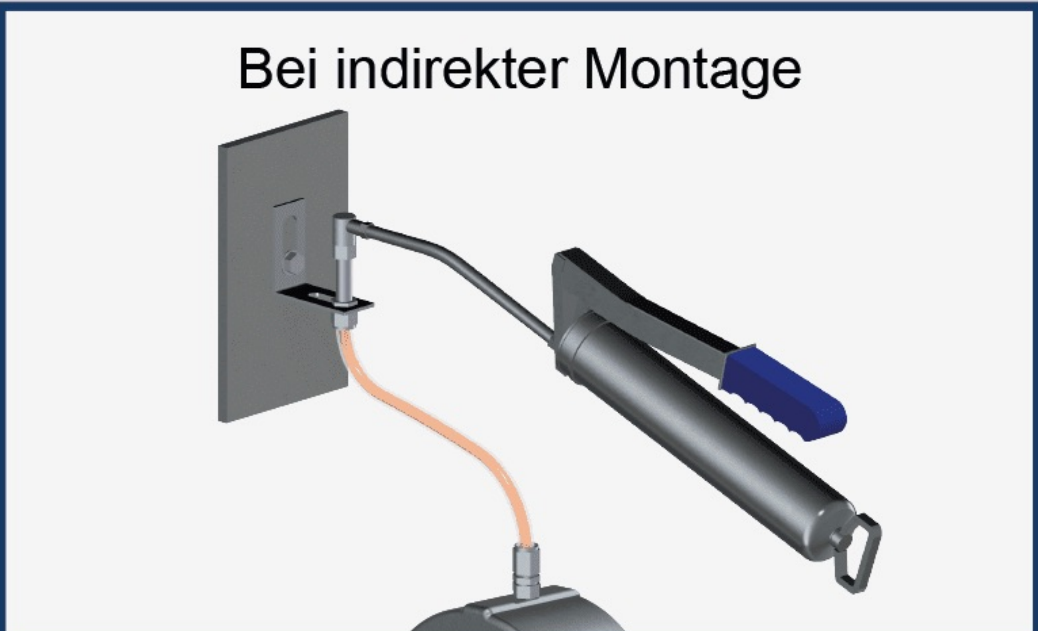
Schmierstelle und Schlauchleitung mit identischem Schmierstoff füllen
