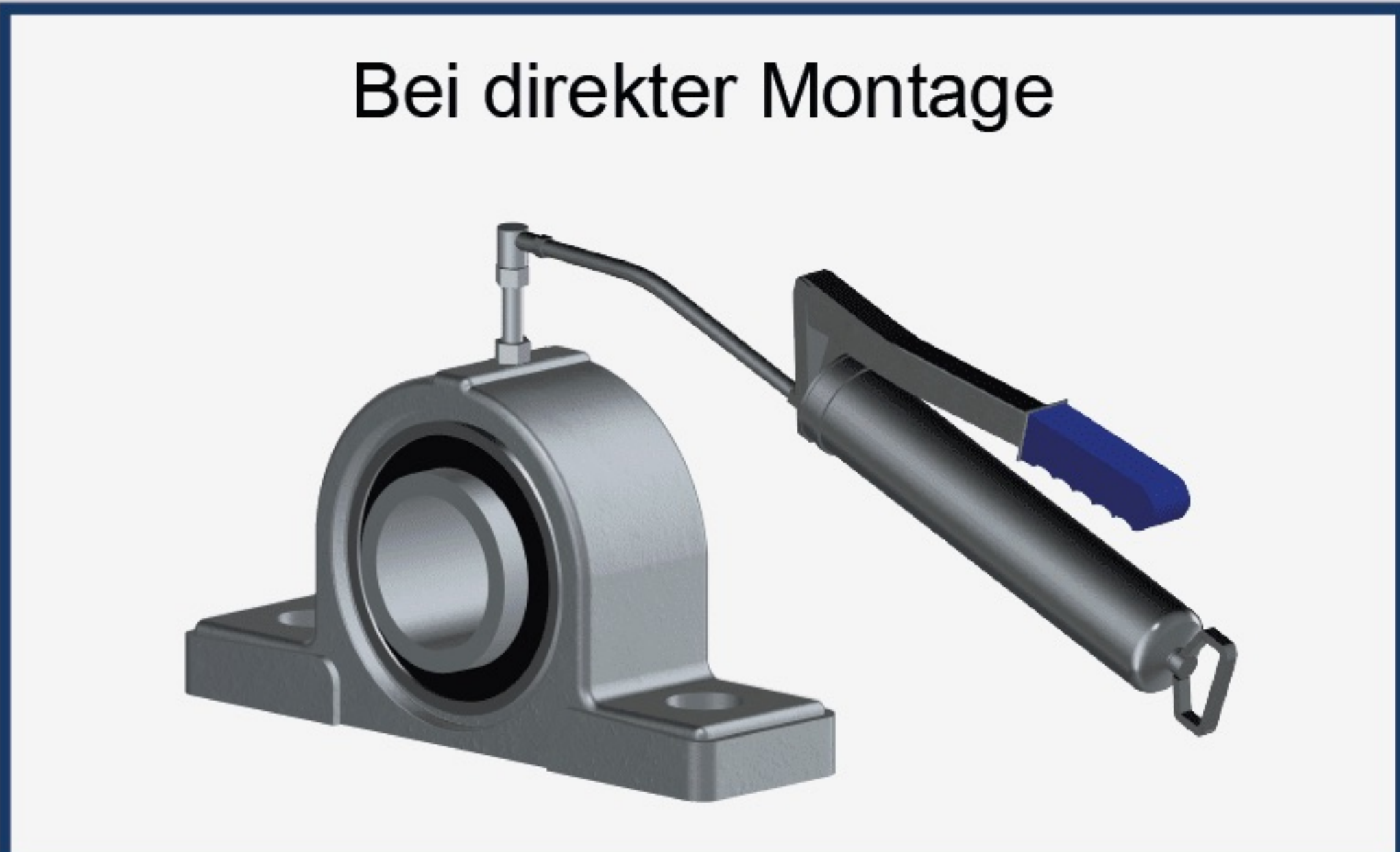
Schmierstelle und Anschlusssteile mit identischem Schmierstoff füllen
