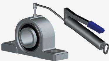
Schmierstelle und Anschlusssteile mit identischem Schmierstoff füllen
